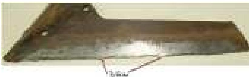
**Рис 2 – Износ режущего лезвия культиваторных лап**
