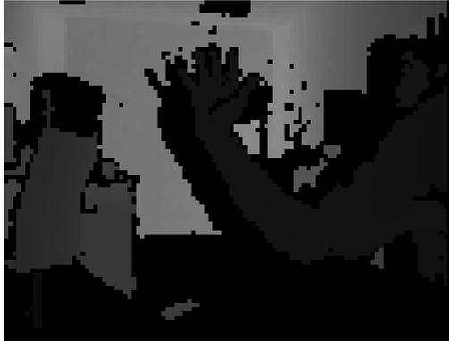
**Рис. 1 – Карты глубины, камера Orbbec Astra Pro**
