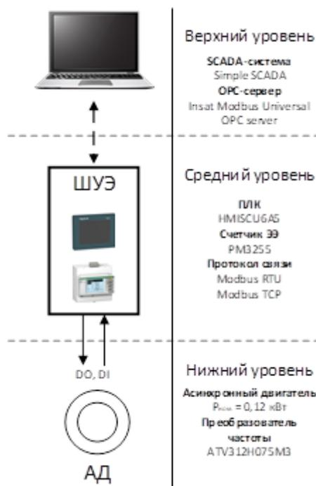
Структура системы электроснабжения с применением ПЛК и SCADA системы
