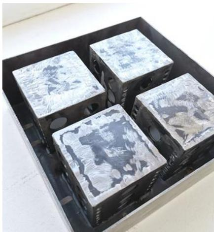
Рис.1. Полупромышленная модель мультивихревого сепарационного устройства
