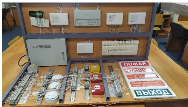
Рис. 1. Стенд по автоматизированным системам пожаротушения
