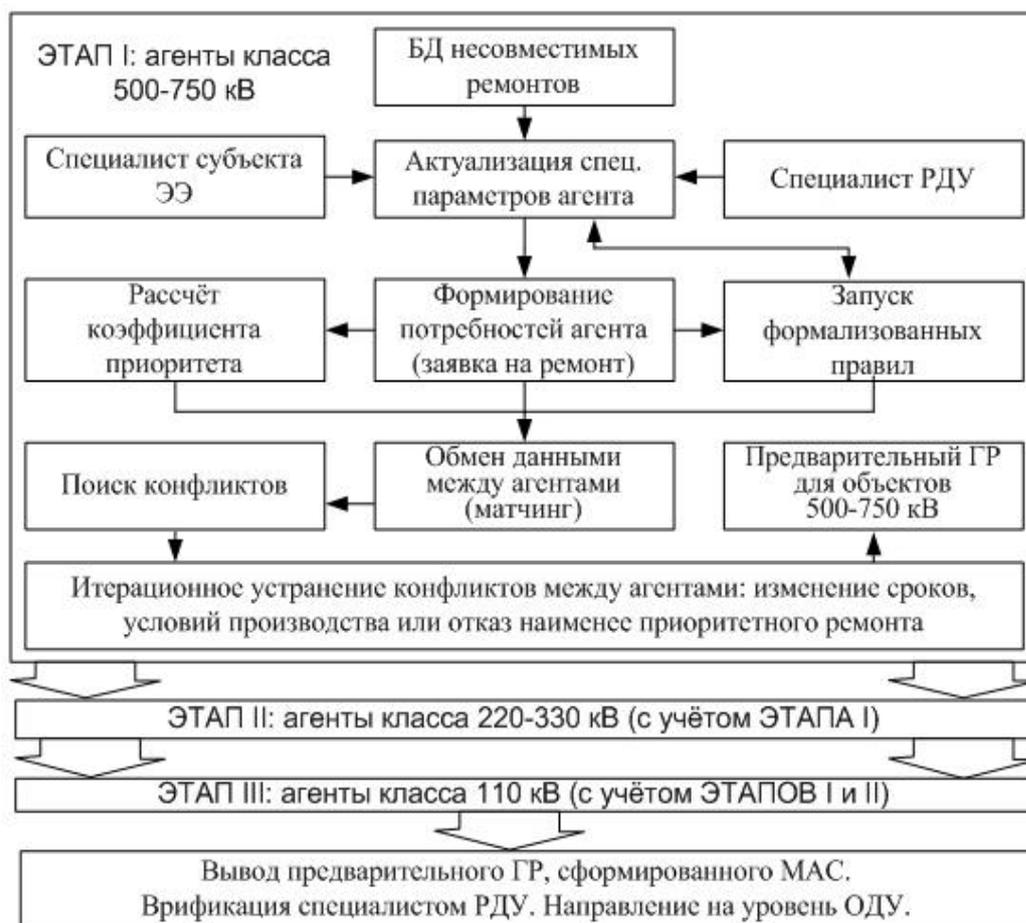
Рис. 1. Этапы автоматизированного формирования предварительного ГР
