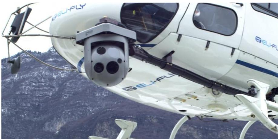
Рис.1. Мультиспектральная система TrakkaTS300
