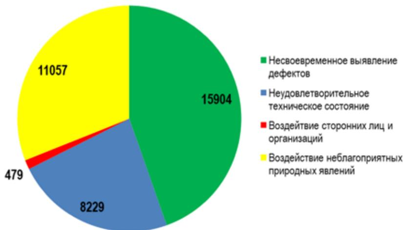
Рис. 2. Анализ причин аварий на воздушных линиях электропередачи распределительных сетей 0,4–20 кВ
