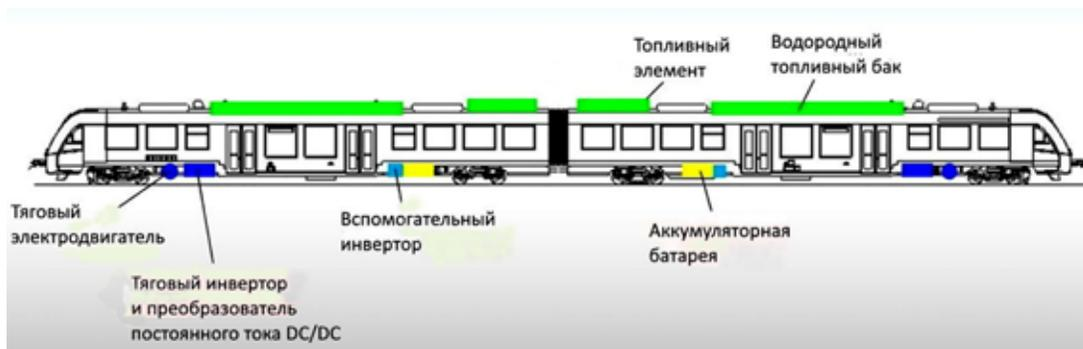
Рис. 8. Базовая комплектация в составе двух вагонов ГПП Coradia iLint
