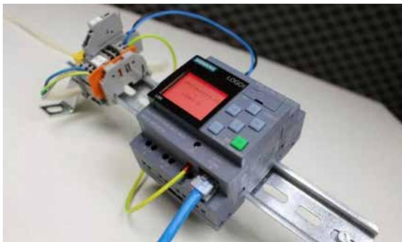
Рис. 8. Пример модульного ПЛК на дин-рейке
