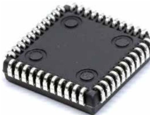
Рис. 8. Внешний вид 3-фазного драйвера 600 В 240 мА (PLCC-44) фирмы IR
