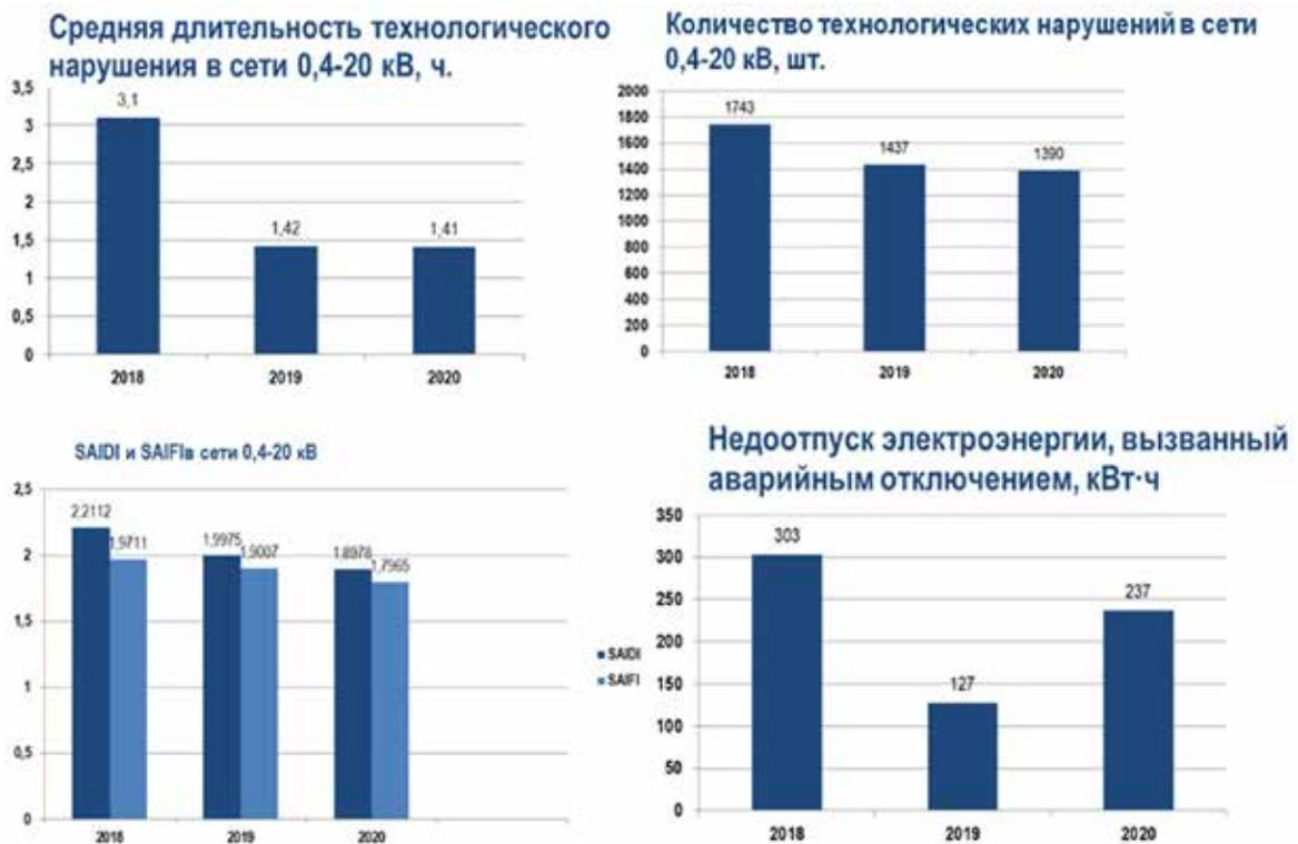
Рис. 1. Анализ аварийности в распределительных электрических сетях 0,4–20 кВ
