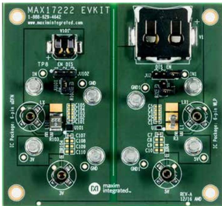
Рис. 5. Внешний вид отладочной платы MAX17222EVKIT
