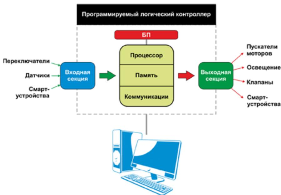
Рис. 1. Архитектура и состав ПЛК
