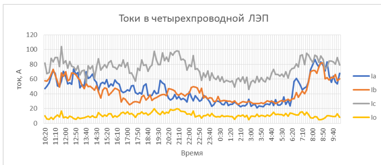
Рис. 1. Токи фаз ЛЭП 0,4 кВ
