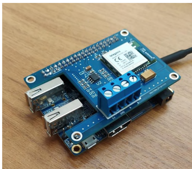
Рис. 5. Опытный образец модуля преобразователя данных, установленный на промышленный контроллер
