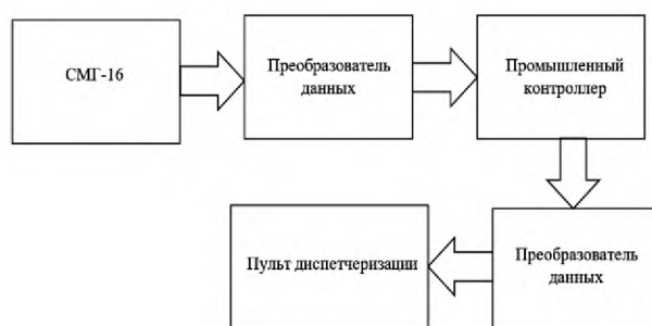
Рис. 2. Блок схема системы сбора данных об образовании гололеда на ВЛЭП
