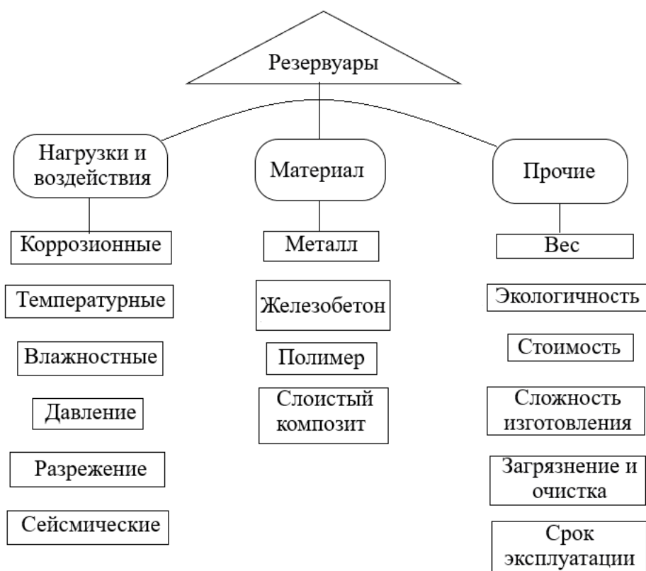
Рис. 1. Обобщенная схема наиболее важных параметров резервуара ГСМ, зависящих от конструкционного материала
