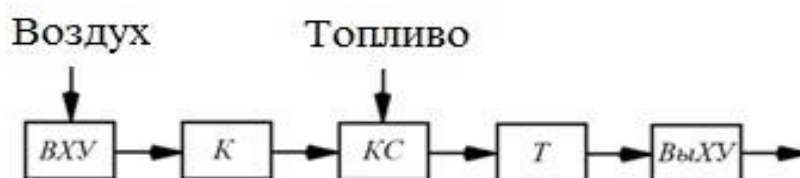
Рис.1. Функциональная схема моделируемой газовой турбины
