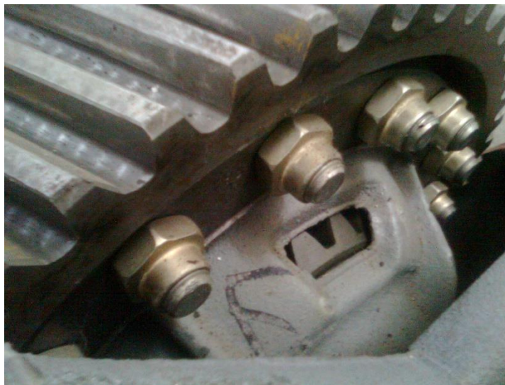
Рис. 1. Блокируемый межколёсный дифференциал автомобиля КАМАЗ
