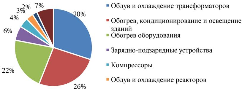
Рис. 1. Структура расхода электроэнергии на СН ПС
