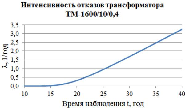
Рис. 1. График интенсивности отказов трансформатора ТМ-1600/10/0,4
