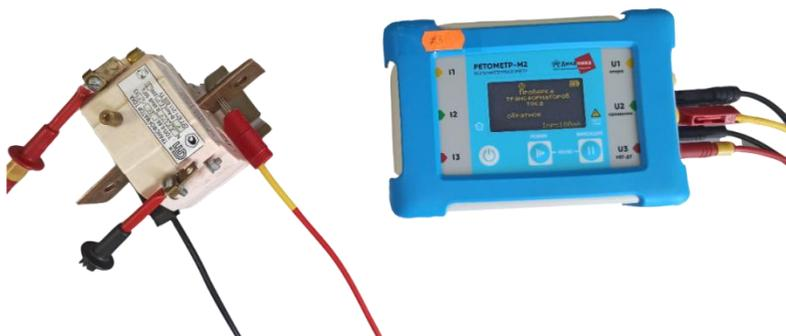
Рис. 3. Проверка полярности ТТ с помощью ВАФ РЕТОМЕТР-М3
