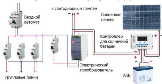
Рис. 2 Схема системы низковольтного светодиодного освещения с применением ВИЭ (солнечной батареи)
