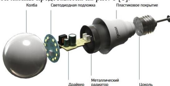
Рис. 1 Внутренняя конструкция светодиодной лампы для сети с переменным напряжением 220 В
