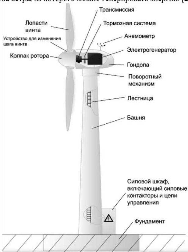
Рис. 1 Схема устройства ветрогенератора
