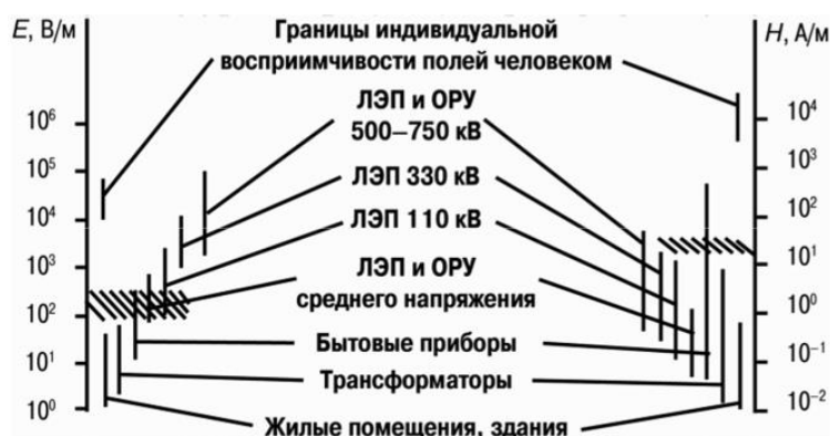
Характерные напряженности электрических и магнитных полей промышленной частоты
