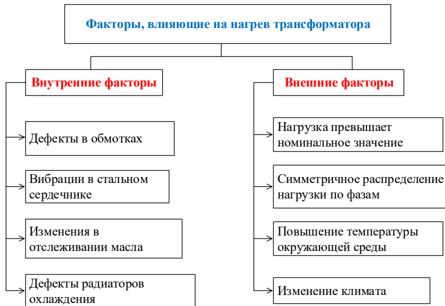
Рис. 1. Факторы, влияющие на нагрев силового масляного трансформатора
