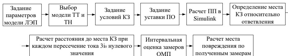
Рис. 2. Блок-схема алгоритма ОМП: ПП – переходный процесс, ПО – пусковой орган
