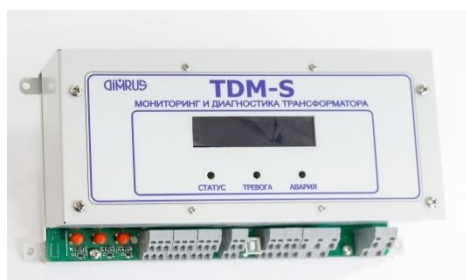
Рис. 1. Система TDM-35S для мониторинга силовых трансформаторов с литой изоляцией с рабочим напряжением 10-35 кВ
