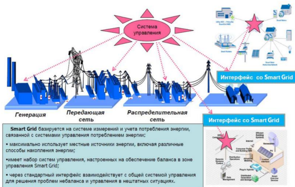
Рис. 2. Smart Grid как элемент интеллектуальной электроэнергетической системы
