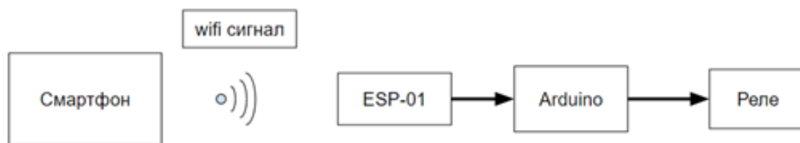
Функциональная схема дистанционного устройства управления реле на базе модуля ESP-01
