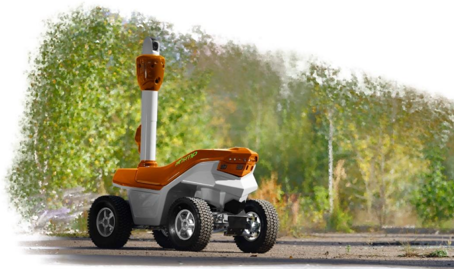
Рис. 1. Самоходный инспектор Outdoor robot S3.2 [3]
