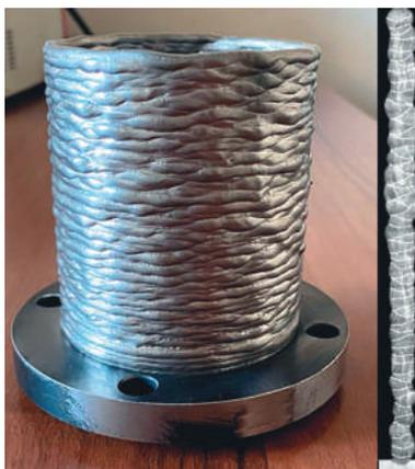
Рис. 5. Фото наплавленного цилиндра. Справа — макрошлиф изделия
