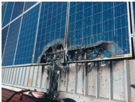
Рис. 1. Поврежденный пожаром фотоэлектрический модуль [5]
