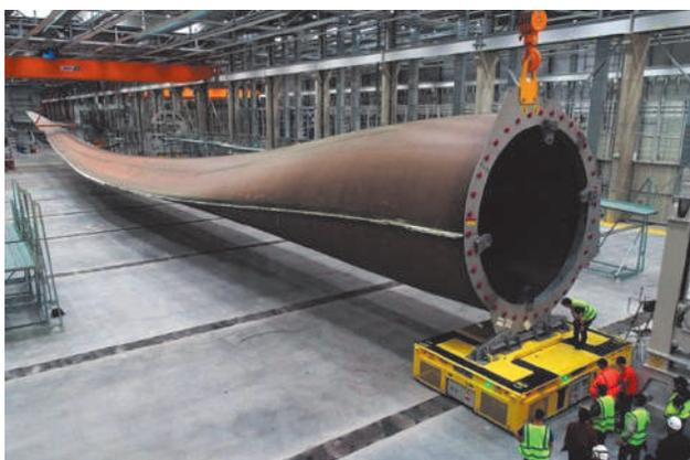
Рис. 4. Крупнейшая в мире лопасть ветроустановки — первая, превзошедшая длину 100 м
