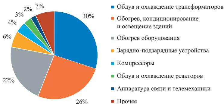
Рис. 1. Структура расхода электроэнергии на СН ПС
