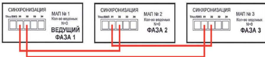
Рис. 2. Схема синхронизации МАП HYBRID 48–4.5
