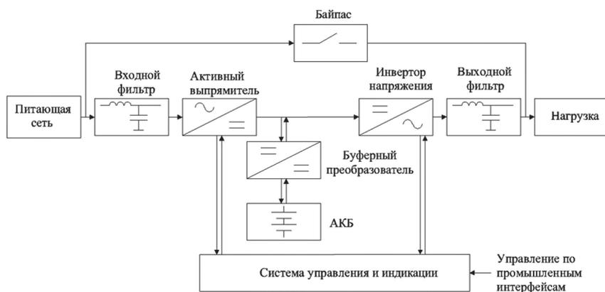
Рис. 1. Функциональная схема проектируемого ИБП
