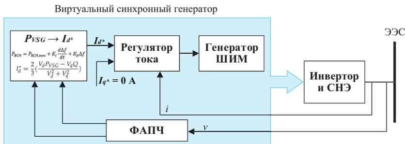
Рис. 1. Модель СВИ на основе связи частоты и мощности [4]
