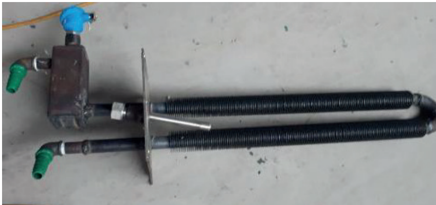
Рисунок 1 – Экспериментальный блок рекуперативного теплообменного аппарата
