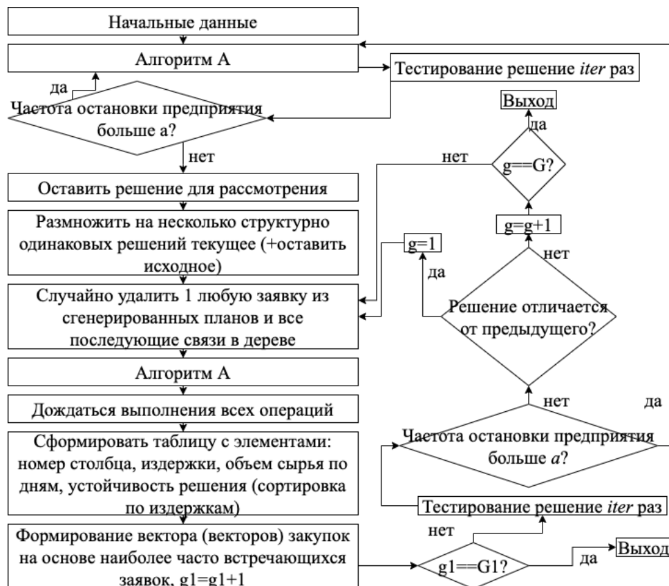
Рисунок 2 – Визуализация схемы поиска субоптимального решения (Алгоритм В)
