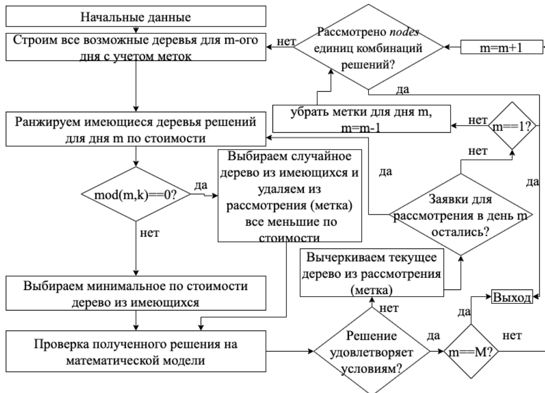
Рисунок 1 – Визуализация схемы поиска допустимого решения (Алгоритм А)
