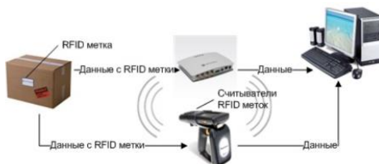
Принцип работы RFID-системы
