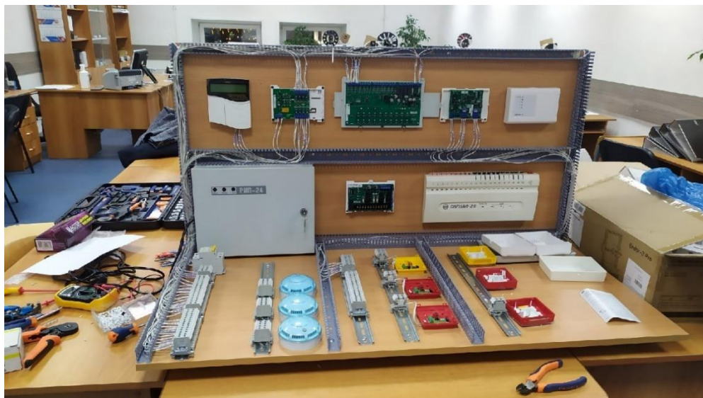
Стенд по автоматизированным системам пожаротушения
