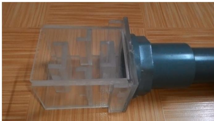
**Рис. 1.** Сепаратор с двутавровыми вставками внутри аппарата
