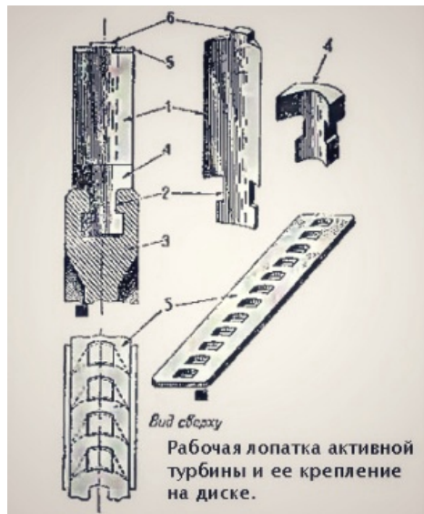
Рисунок 1 – Рабочая лопатка автовной турбины и ее крепление на диске
