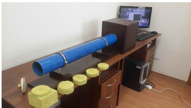
Рис. 1. Фотография интерферометра на частотный диапазон 125–2000 Гц
