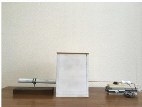
Рис. 2. Фотография интерферометра на частотный диапазон 1600–8000 Гц
