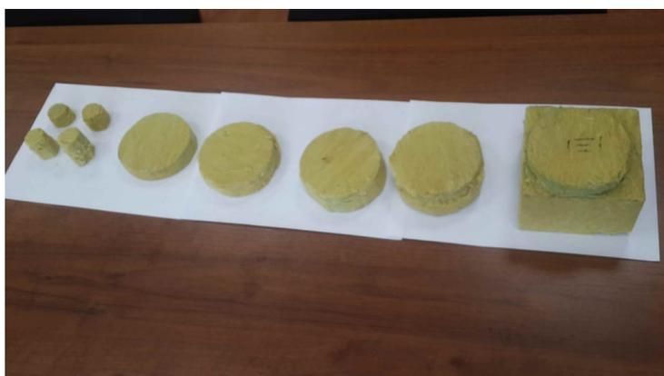
Рис. 3. Исследуемые образцы базальтовой теплоизоляции
