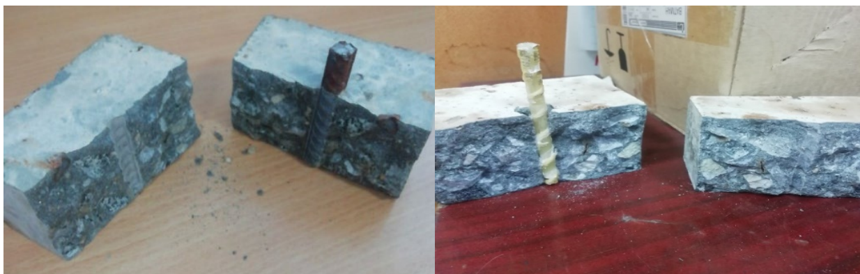
Рисунок 3. Образцы со стальной и стеклопластиковой арматурой после испытаний
