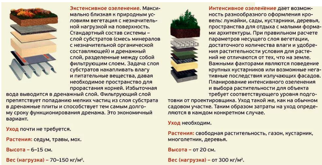
Рисунок 1. Типы «зеленых» крыш
