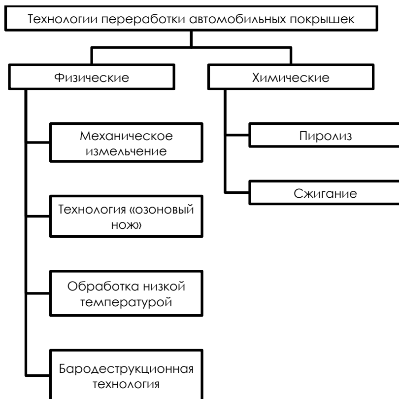
Рисунок 1 – Классификация технологий по переработке автошин
