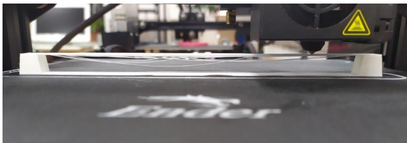
Рисунок 2 - Провисание нижнего слоя нависающей части модели «Мост»
