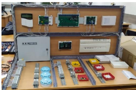
Рисунок 1 – Стенд по автоматизированным системам пожаротушения
