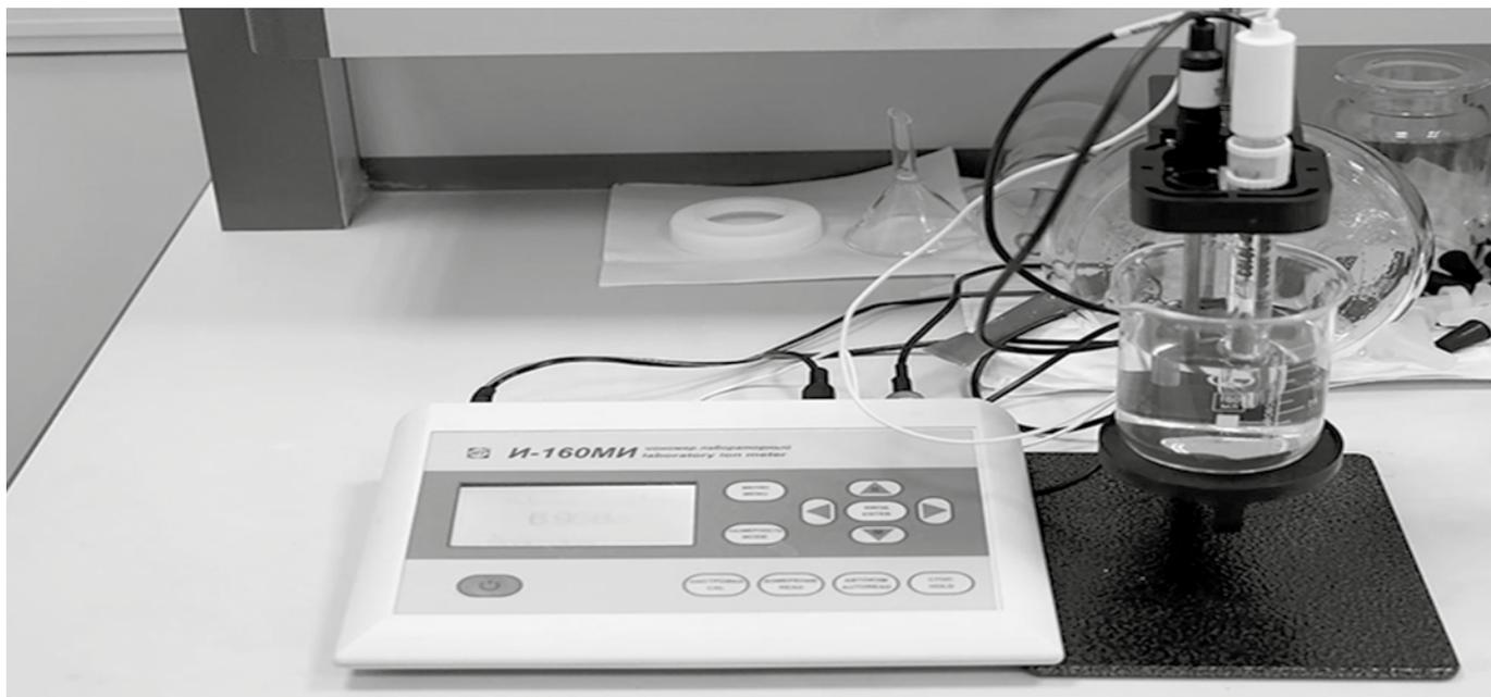
Рис.1. Ионометр лабораторный И-160 МИ
