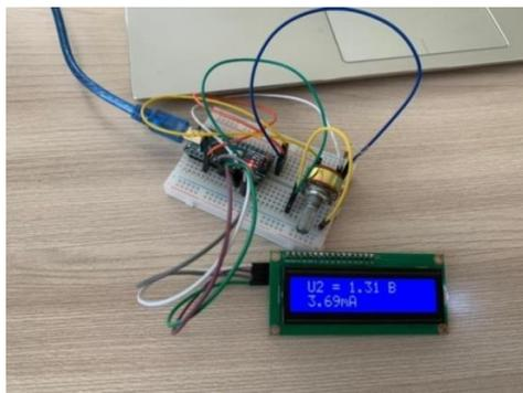
Рис. 1. Макет прибора на базе микроконтроллера
