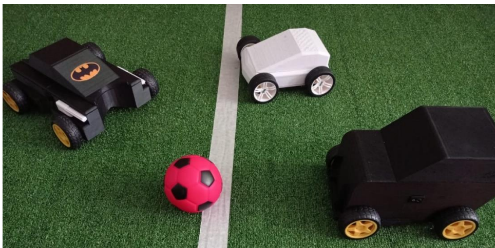
Разработанные мобильные платформы на Arduino
