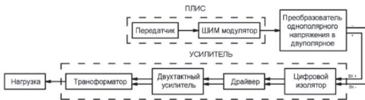
Рис. 1. Структурная схема блока формирования гидроакустических сигналов
