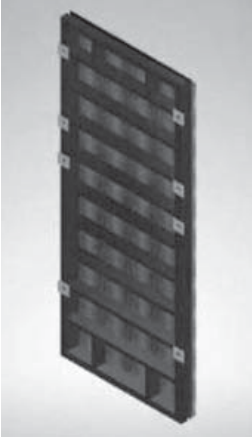
Рис. 1. Параметрическая модель линейного щита опалубки
