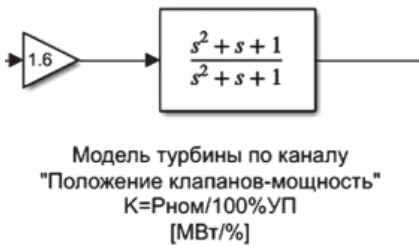
Рис. 1. Упрощённая модель канала «положение клапанов — мощность» газовой турбины
