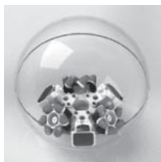
Рис. 1. Сфероробот [2] с внутренней платформой, имеющей три меканум-колеса
