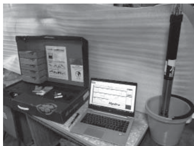
Рис. 1. Комплекс для анализа качества воды на Aqua TROLL 600
