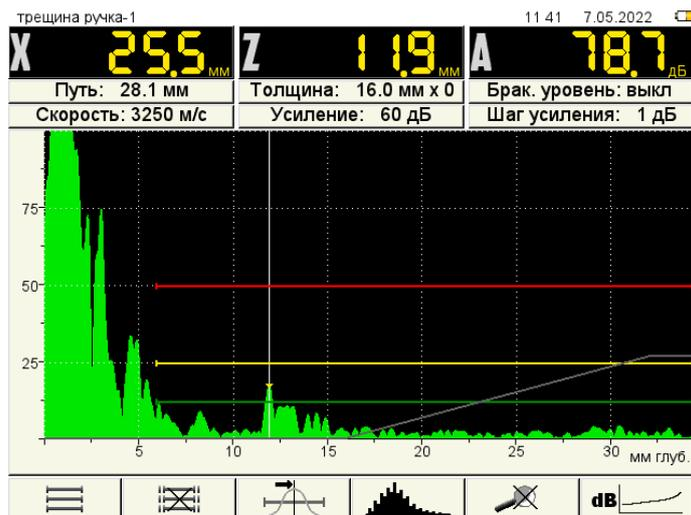
Рис. 3. Эхо-сигнал от поперечной трещины при сканировании под углом 90 градусов прямым лучом
