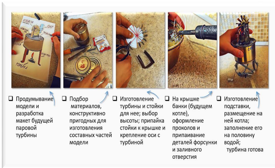
Рис. 2. Этапы изготовления паровой турбины
