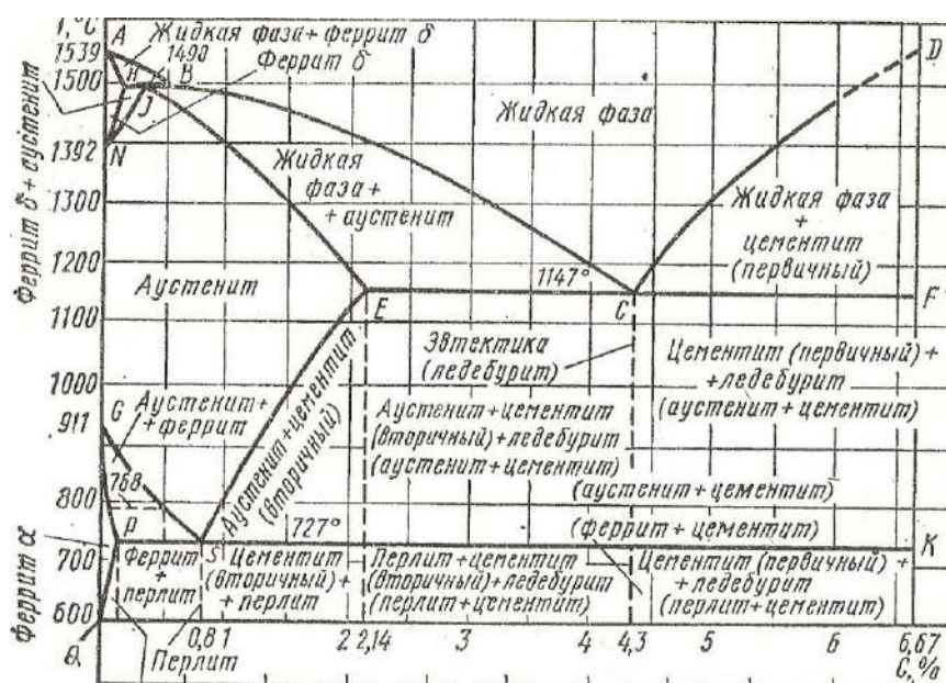
Рисунок 1 - Диаграмма состояния железо-цементит
