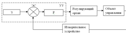
Рис.1. Структурная схема автоматизации.
