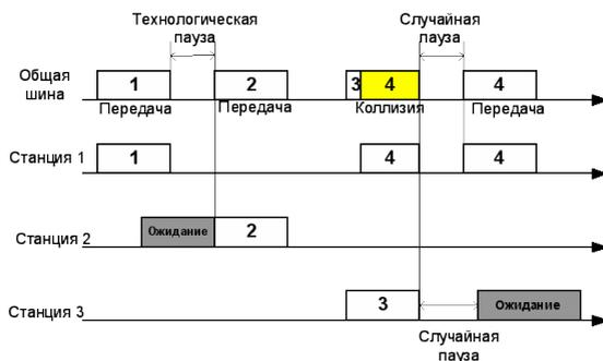
Рис. 1. Метод доступа CSMA/CD
