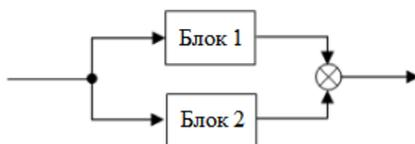
Рис.3. Параллельное подключение блоков САУ.
