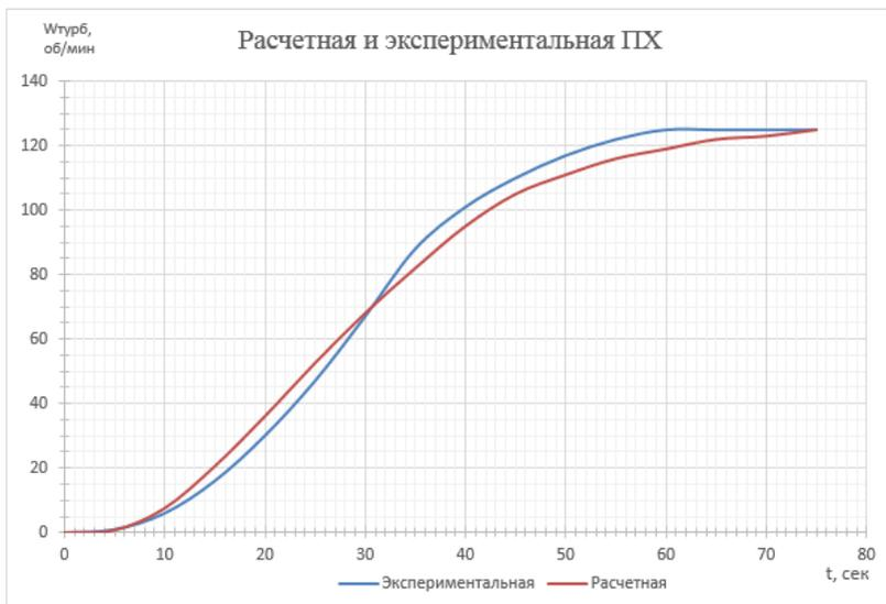
Рис.5. Расчетная и экспериментальная переходные характеристики
