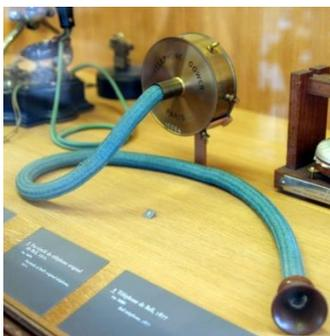
Рис.2. Копия телефонного аппарата, созданного А. Беллом
