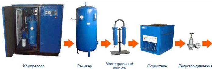
Рис.2. Классическая схема пневмоустановки на реальных объектах
