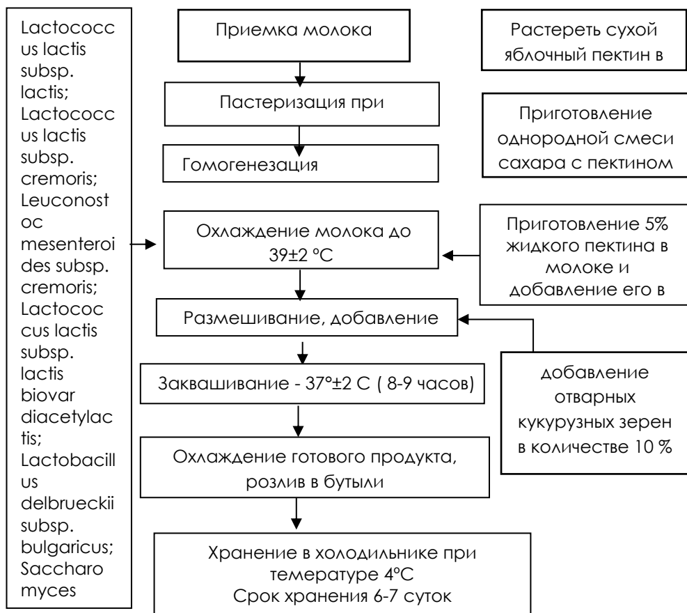
Рисунок 2 – Технологическая схема приготовления пектинсодержащего напитка «Кеже»
