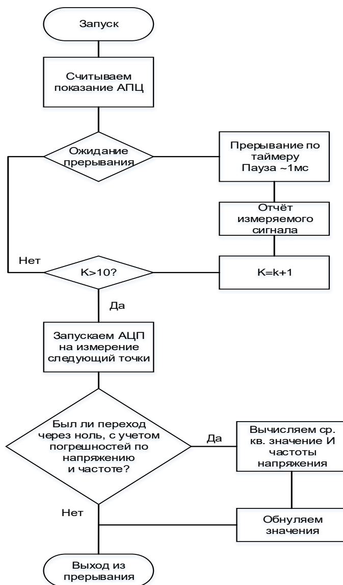
Алгоритм измерения истинного среднеквадратичного значения переменного напряжения
