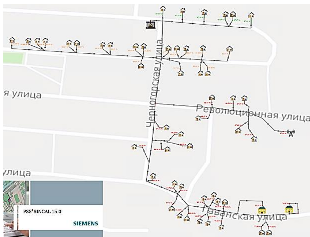
Поопорная схема электроснабжения электрической сети с результатом расчета в ПК
