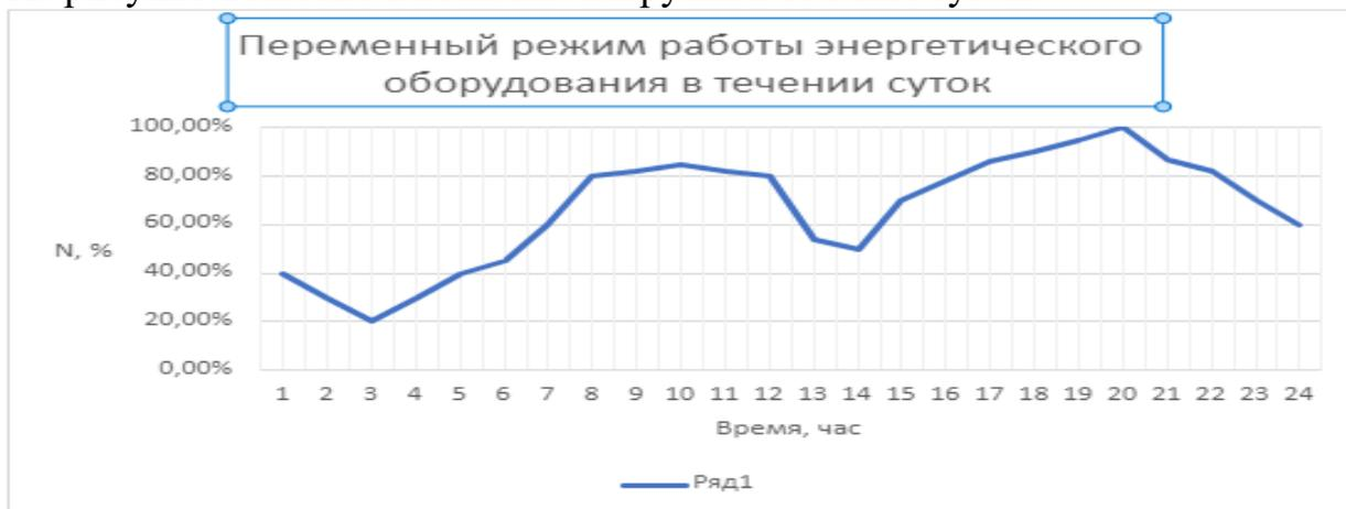
Переменный режим работы энергетического оборудования в течении суток
