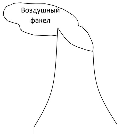
Рис. 2. Градирня с наклонной выходной плоскостью [4]
