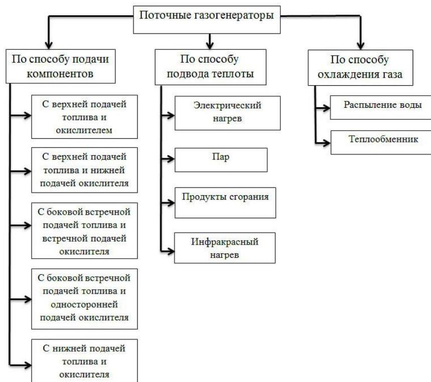
Классификация поточных газогенераторов
