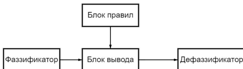
Рис. 1. Структурная схема нечеткого контроллера
