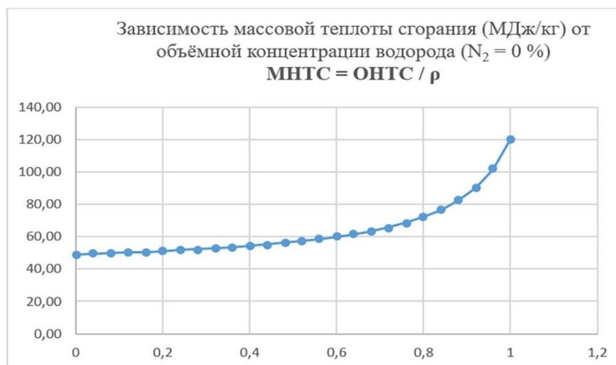
Рис. 3. Зависимость массовой теплоты сгорания (МДж/кг) от объёмной концентрации водорода
