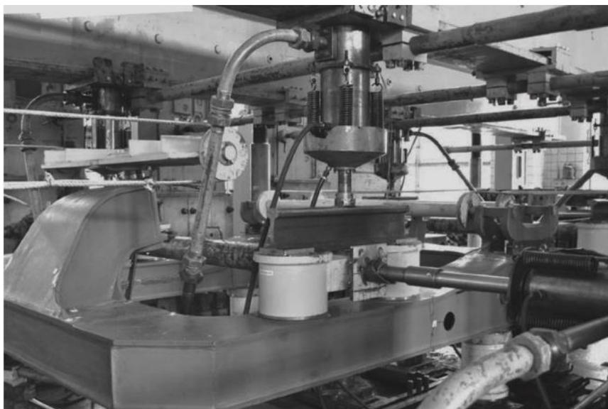
Рисунок 2. Стенд для проведения вибрационных испытаний с установленной на нем рамой тележки электровоза.
