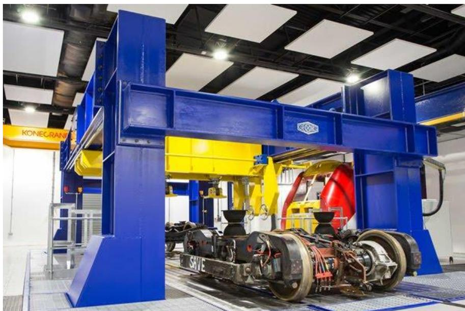
Рисунок 2. Вагонная тележка с боковой рамой из углеволокна [3].
