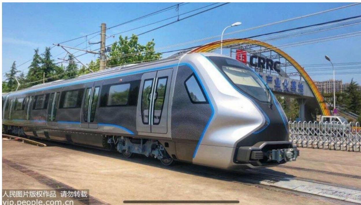
Рисунок 3. Прототип локомотива с углепластиковым кузовом [4].
