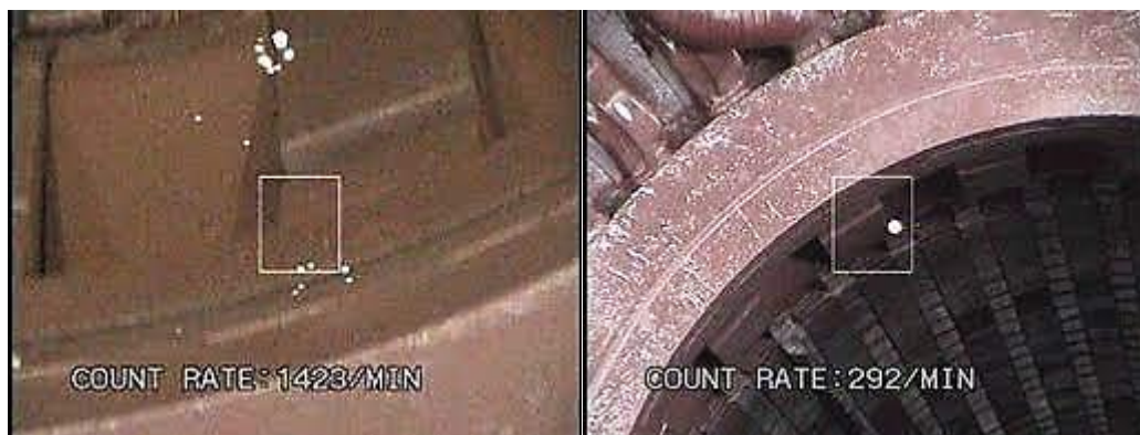
Рис. 1. Ультрафиолетовая фотография фрагментов поверхности лобовой части на прессующем диэлектрическом кольце при 31кВ в увеличенном виде (область № 32 и 16 паза) разрядные области выхода стержней из паза оптически недоступны (число разрядов –1423- 938 /мин.)
