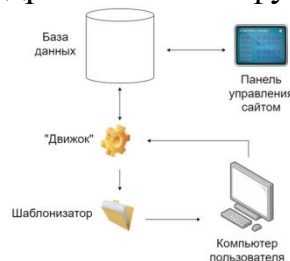
Рисунок 2 – Схема функционирования CMS
