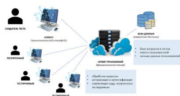
Рисунок 1 – Схема устройства приложения тестирования
