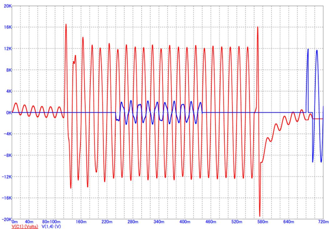
Рис. 8. Осциллограммы напряжений на ёмкости C1 и на межконтактном промежутке KM2
