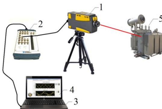
Рис. 1. Схема ЛКИК: 1 – лазерный виброметр PDV-100; 2 – АЦП NI USB-6251; 3 – персональный компьютер; 4 – программное обеспечение LabVIEW; 5 – силовой трансформатор
