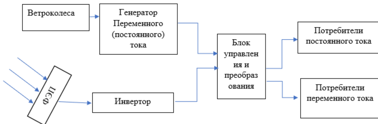
Рис. 3. Примерная структурная схема автономной системы электроснабжения на основе ветроэнергетической установки с резервированием солнечной электростанцией
