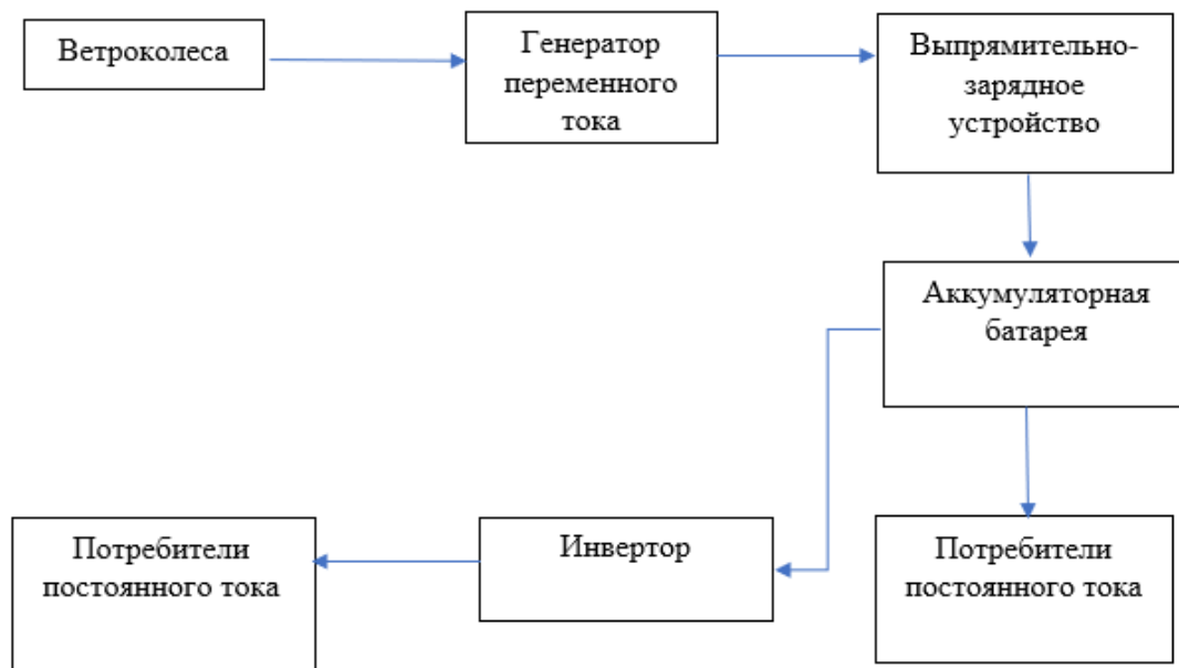
Рис. 5. Структурная схема автономной системы электроснабжения на основе ветроэнергетической установки
