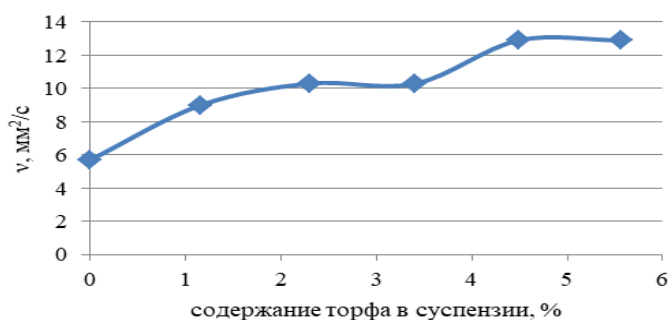
Рис. 3. Изменения кинематической вязкости суспензии «дизельное топливо – торф» Fig. 3. Changes in the kinematic viscosity of the suspension «diesel fuel-peat»
