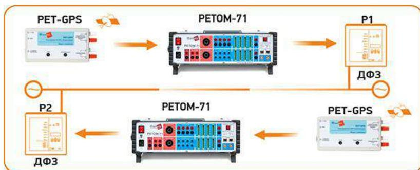
Рис. 2. Синхронная работа комплексов по сигналам GPS
