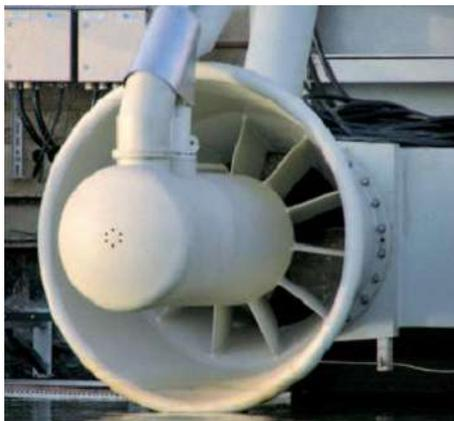
Рис. 1. Генератор с турбиной HYDROMATRIX
