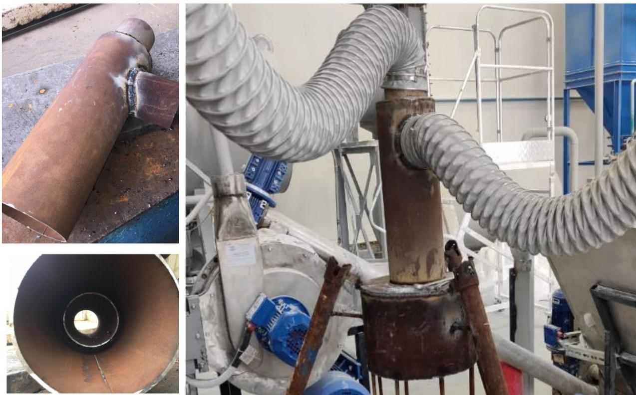
**Рис. 12. Изготовление, апробация и использование классификатора с соосно расположенными трубами на предприятии**
