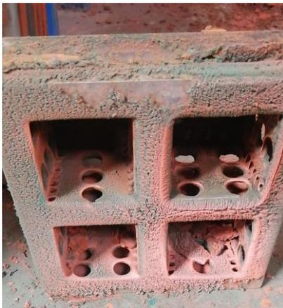
Рис. 3 – Отработанный сепаратор с квадратными элементами после извлечения из вентиляционного канала
