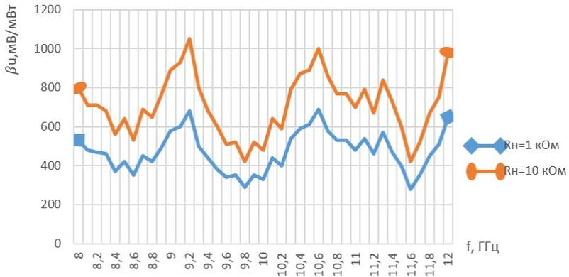
Рисунок 6 – График измерения чувствительности  $\beta_U$  при  $P_{вх} = -10$  дБм
