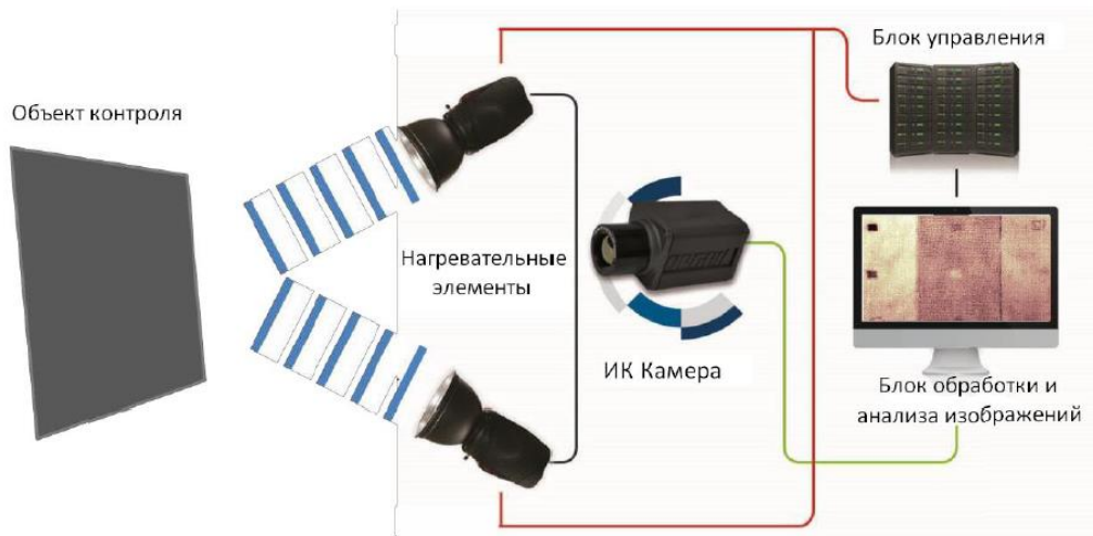
Рис.1. Схема контроля методом активной термографии.
