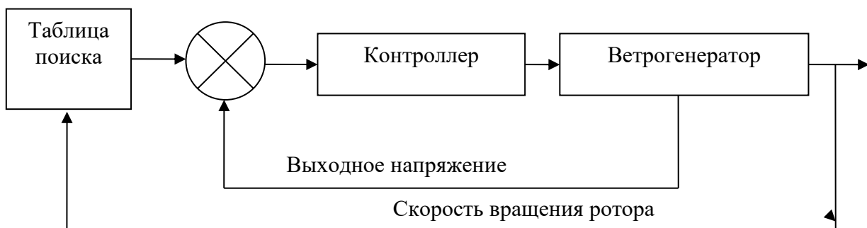
Рисунок 2 – Модель подстройки скорости вращения ротора ветрогенератора методом сигнала мощности обратной связи
