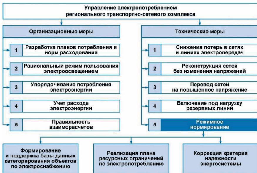
Рис. 3. Место процедуры режимного нормирования при реализации мер повышения энергоэффективности для объектов РТСК
