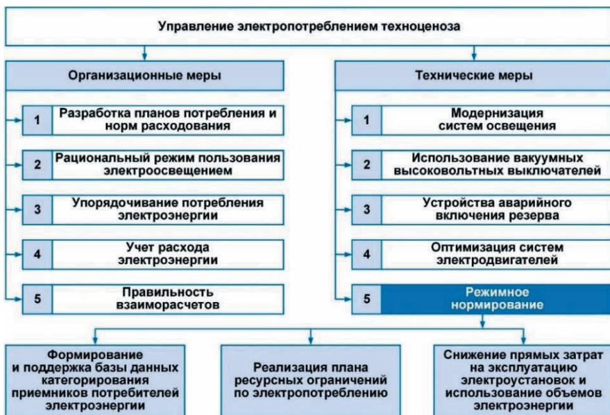
Рис. 4. Место процедуры режимного нормирования при реализации мер повышения энергоэффективности для объектов РЭК
