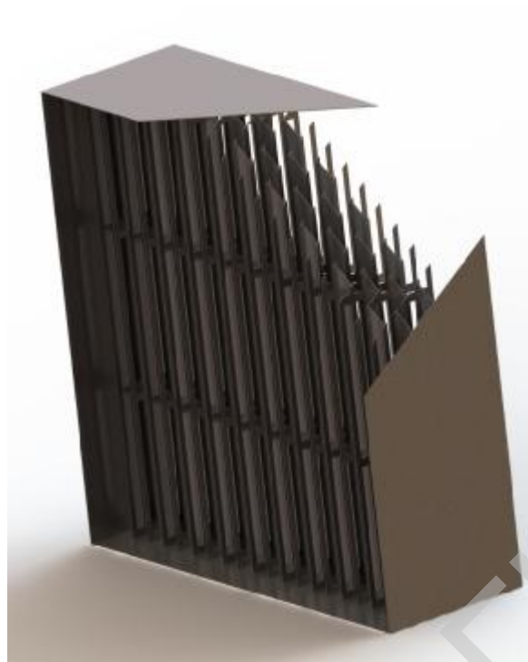
Рисунок 1 – Трехмерная модель сепарационного устройства с двуставровыми элементами
