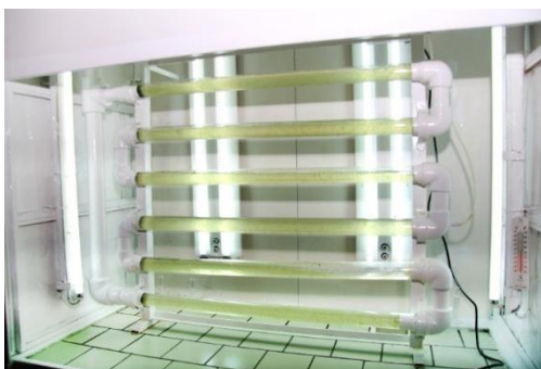
Рис. 2 Испытательный стенд для культивирования хлореллы
