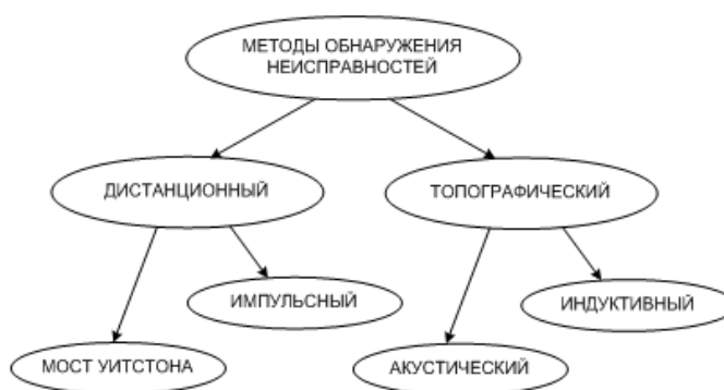
Рис. 2. Методы обнаружения мест повреждения для подземных кабелей
