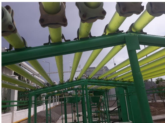
Рис.3 Культивирование Chlorellavulgaris IFR №C-111 в трубчатом фотобиореакторе
