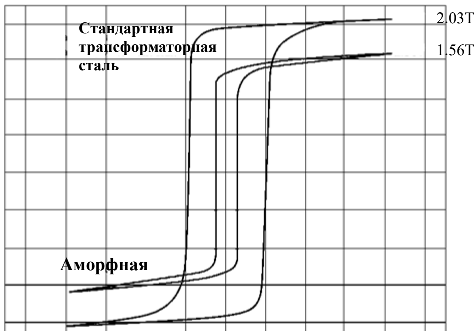
Рис.2.Магнитные характеристики аморфной и электротехнической стали 2.03Т – стандартная электротехническая сталь; 1.56Т – аморфная сталь.
