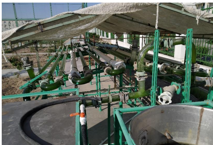
Рис.5 Фотобиореактор с водяной охлаждающей системой и солнце защитным занавесом
