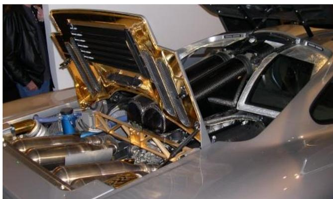
Рис. 4. Тепловая защита деталей автомобиля из золотой фольги
