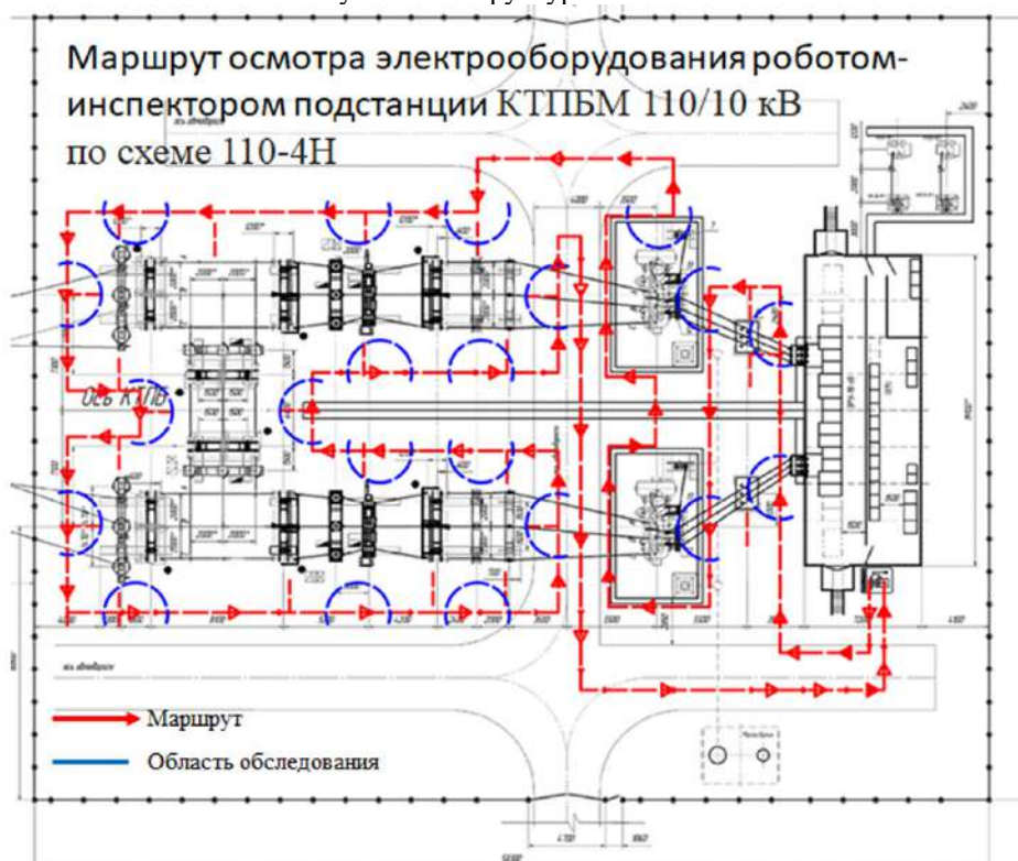
Рисунок 2 – Маршрут обследований электрооборудования
