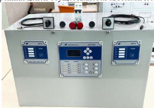
Рисунок 2 – Внешний вид стенда защиты от дуговых замыканий на этапе монтажа
