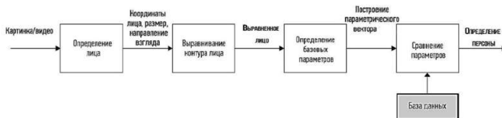
Рисунок 1 – Схема процесса распознавания лица при обработке изображения
