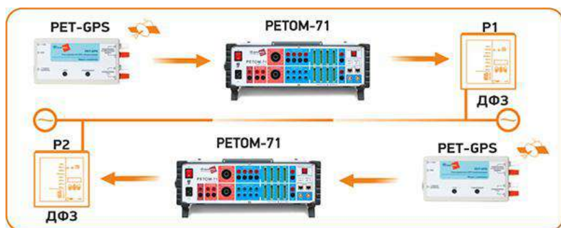
Рис. 2. Синхронная работа комплексов по сигналам GPS
