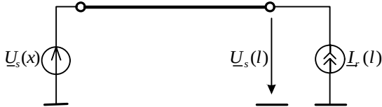
Рис. 3. Алгоритмическая модель сети справа от предполагаемого места повреждения
