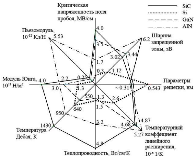
Рис. 1. Диаграмма, показывающая основные свойства полупроводниковых материалов для применения в силовой электронике
