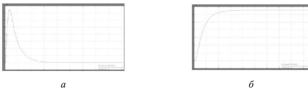
Рис. 4. Графики моментных составляющих ошибок системы при ступенчатом (а) и линейно возрастающем (б) моменте сопротивления
