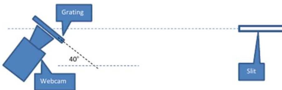
Рис. 2. Оптическая схема матричного спектрометра с дифракционной решеткой на пропускание (образец помещается либо перед щелью, либо непосредственно после нее)
