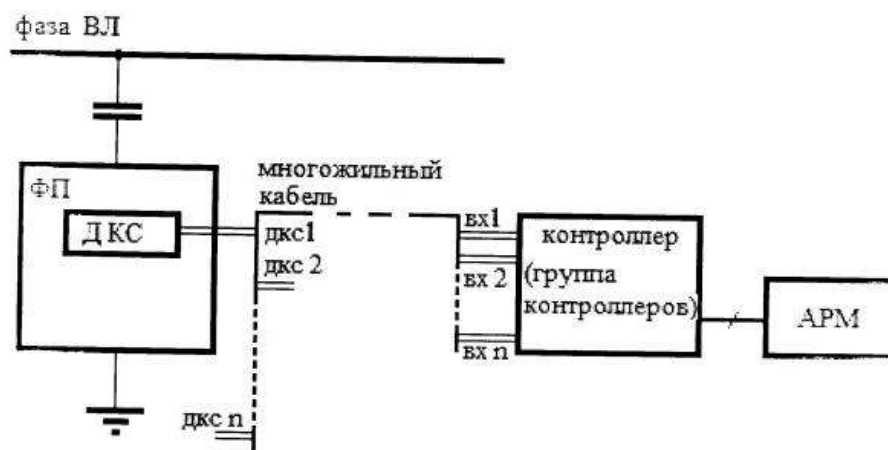
Рис. 1. Структурная схема системы контроля конденсаторов связи с использованием датчика контроля конденсатора связи
