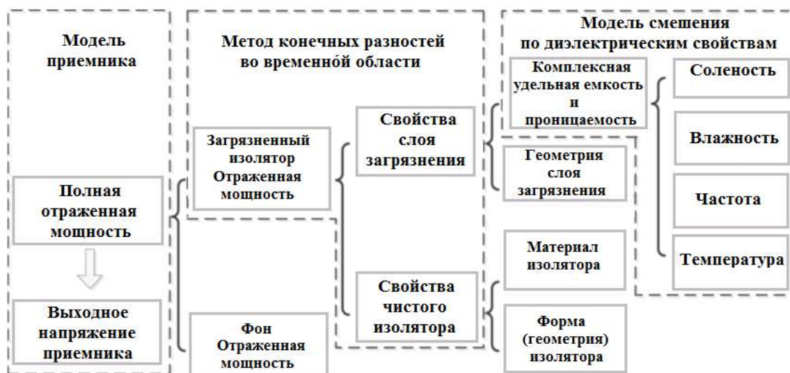
Теоретическая модель применения рефлектометрии для контроля загрязнения изолятора
