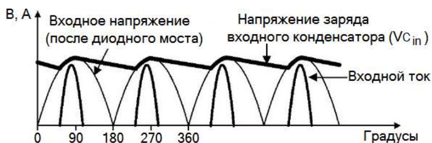
Рис. 1. Форма тока и напряжений во входной цепи ИИП
