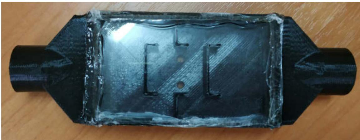
Рис. 1. Фотография П-образного сепаратора, предназначенного для разделения эмульсий
